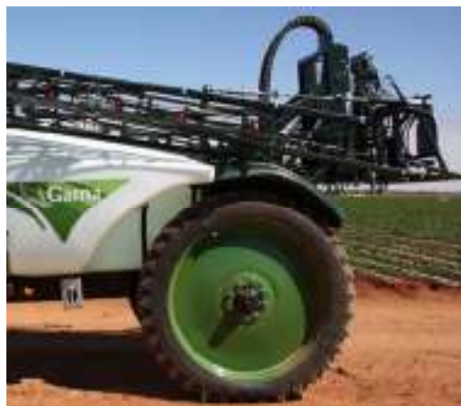
Posibilidad de acoplar barras de plegado lateral
